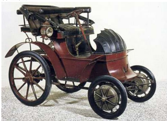
Bild: Das erste von Ferdinand Porsche entwickelte Auto im Jahr 1900 war ein Auto mit Hybridantrieb
