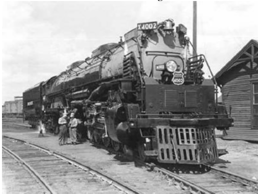
Bild: Stärkste Dampflokomotive aller Zeiten. Die für die Union Pacific im Jahr 1945 gebaute Dampflokomotive Big Boy wiegt 345 Tonnen und hat 6290 PS unter der Haube...
