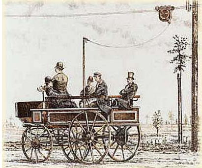
Bild: frühe Testversuche im Jahr 1882 mit einem elektrischen Trolley-Bus
