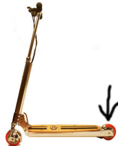
Bild 2: Fussbremse hinten, wird mit Schuh bedient
